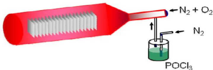
Figura: Difusión de fósforo en un horno de tubo
